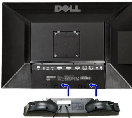
1. Desde la parte trasera del monitor, acople la Barra de Sonido alineando las dos ranuras con las dos pestañas de la parte trasera e inferior del monitor.
